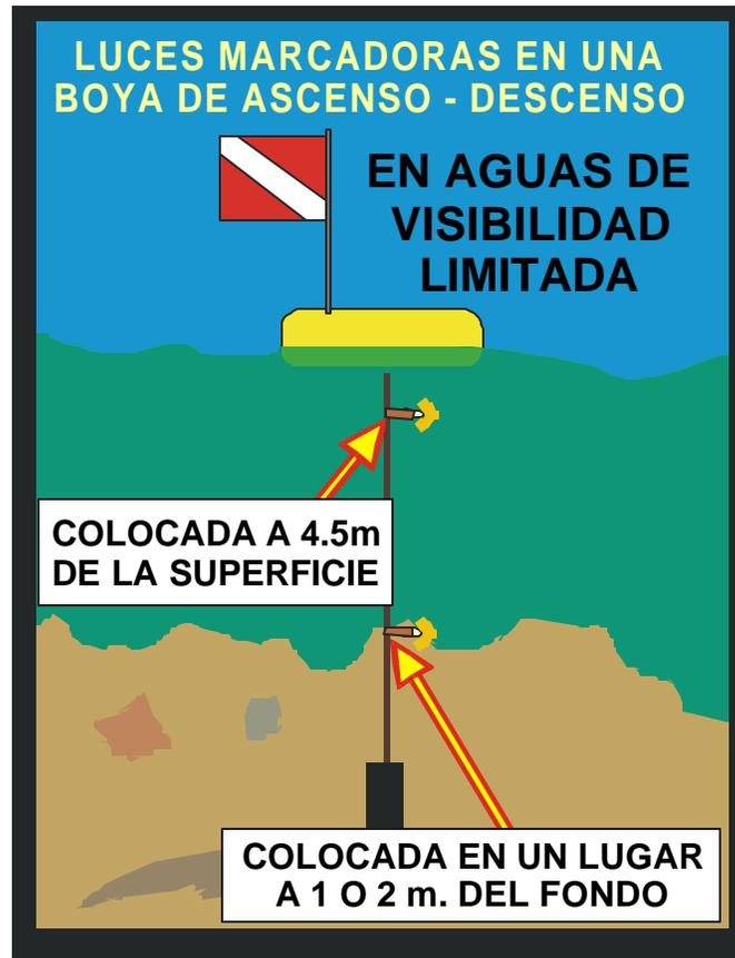
Las características de las luces marcadoras, van de acuerdo a su utilización: en la superficie, ya sea en tierra firme o en una embarcación, pueden usarse prácticamente cualquier tipo de lámparas, mientras que las utilizadas bajo el agua, deberán ser lámparas de tipo estanca. En cualquier caso es recomendable utilizar luces intermitentes y de preferencia de tipo estroboscópico, ya que el haz de este tipo de luz es muy potente y penetrante, lo que hace muy fácil su localización.
