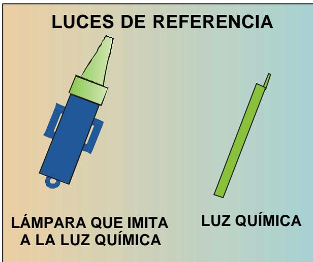
Este tipo de luces se utilizan únicamente como referencia para localizar y ubicar a los buzos, ya sea durante el transcurso de una inmersión, o en la superficie del agua.
